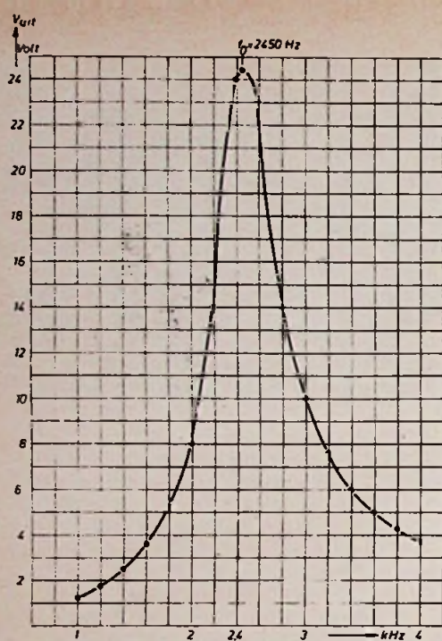
Fig. 91. Doorlaatkromme van de combinatie versterker met RC-filter en de smalleband-versterker.
